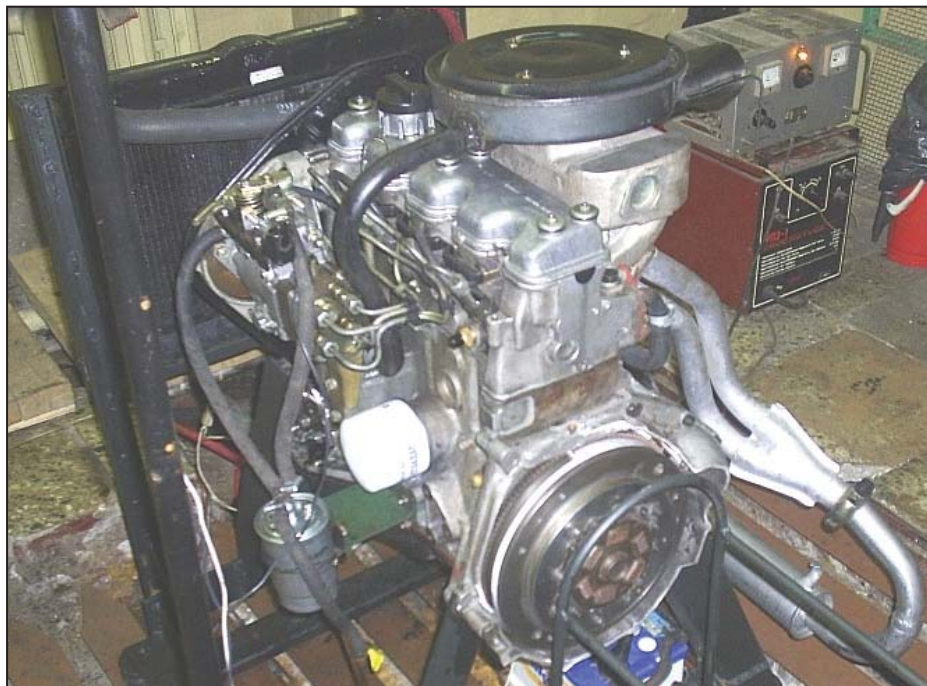
Рис. 1. Экспериментальный стенд с вихрекамерным дизельным двигателем 4ЧН 7,6/8,4
