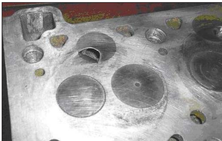
Рис. 2. Модернизированная вихревая камера сгорания со степенью сжатия 38
