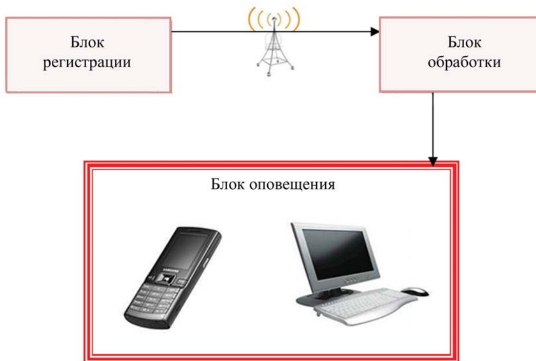
Рис. 1. Структурная схема системы автоматизированного контроля деформаций ГТС
