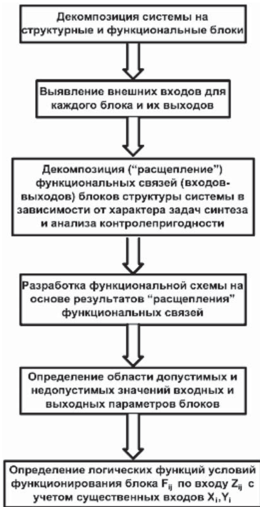
Рис. 3. Формализованная схема построения логической модели системы для анализа ее контролепригодности
