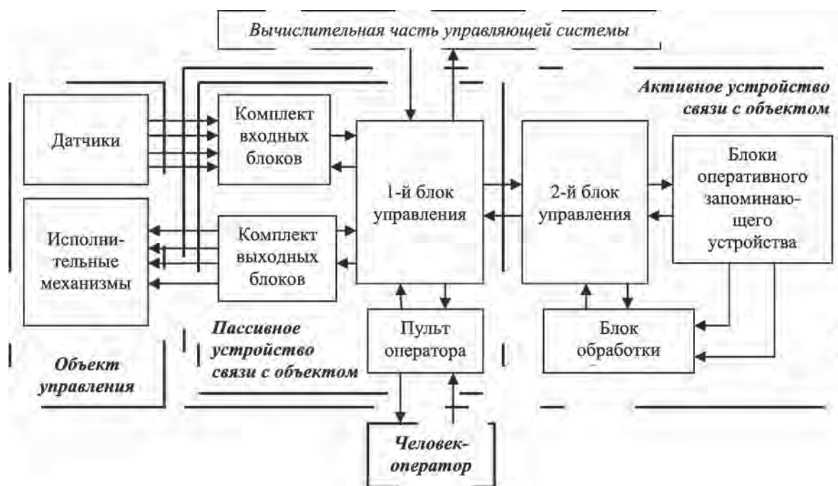
Рис. 1. Блок-схема устройства связи с объектом
