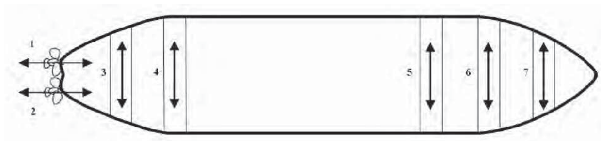
Рис. 2. Схема расположения движителей бурового судна «В. Шашин»
