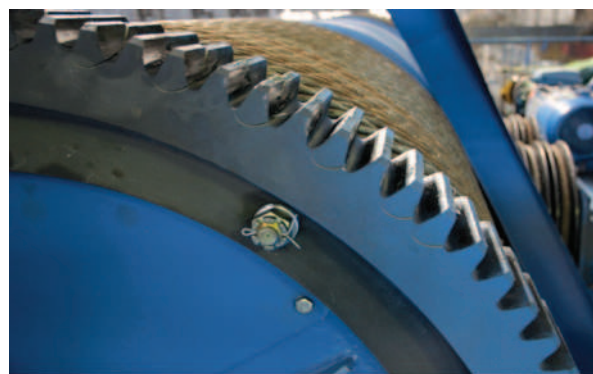
Рис. 3. Краевые поломки зубьев колеса, вызванные неравномерностью распределения нагрузки по ширине зубчатого венца
