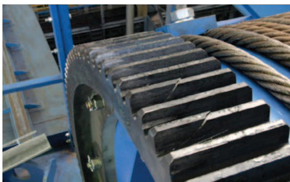
Рис. 3. Краевые поломки зубьев колеса, вызванные неравномерностью распределения нагрузки по ширине зубчатого венца
