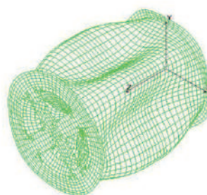
Рис. 11. Формы потери устойчивости различных конструкций барабана
