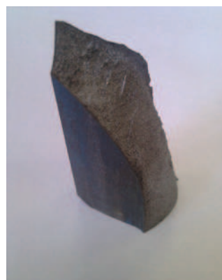
Рис. 2. Фрагмент краевой поломки зуба колеса открытой пары
