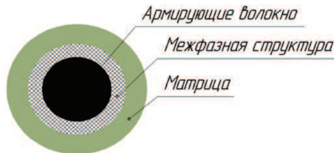
Рис. 3. Трехфазная модель строения композиционного материала
