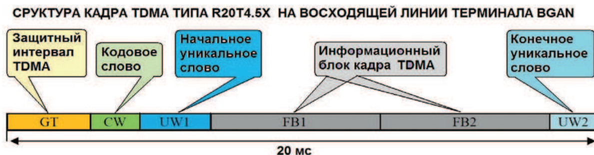
Рис. 2. Структура кадра TDMA типа R20T4.5X на восходящей линии терминала BGAN
