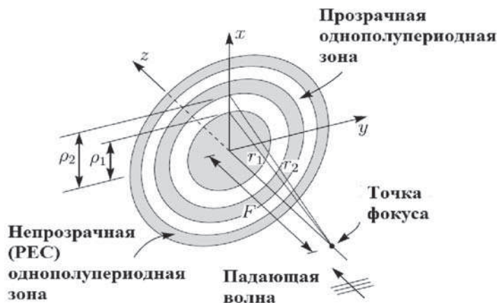
Рис. 2. Геометрия зональной пластины Соре
