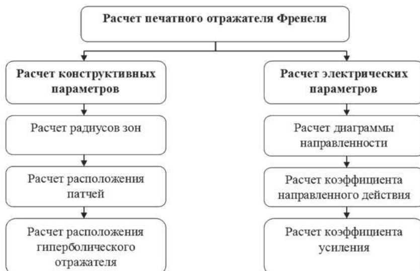
Рис. 3. Блок-схема этапов расчета плоского печатного отражателя Френеля
