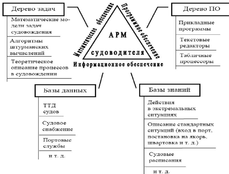
Рис. 1. Основные компоненты автоматизированного рабочего места судоводителя
