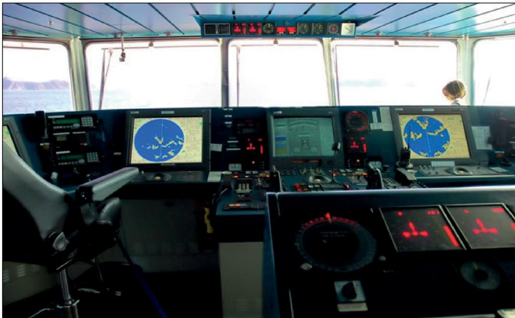
Рис. 2. Автоматизированное рабочее место судоводителя, разработанное в рамках проекта CASCAD
