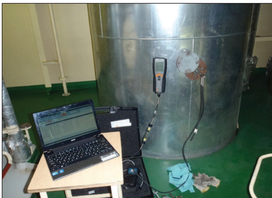
Рис. 1. Место отбора отработавших газов главного двигателя
