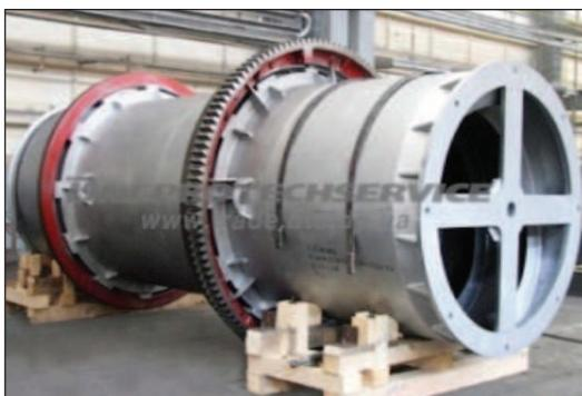
Рис. 7. Технологический барабан с зубчатым венцом, упрочненным плазменной закалкой
