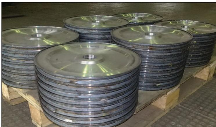
Рис. 8. Канатный барабан (слева) и шкивы, упрочненные плазменной закалкой
