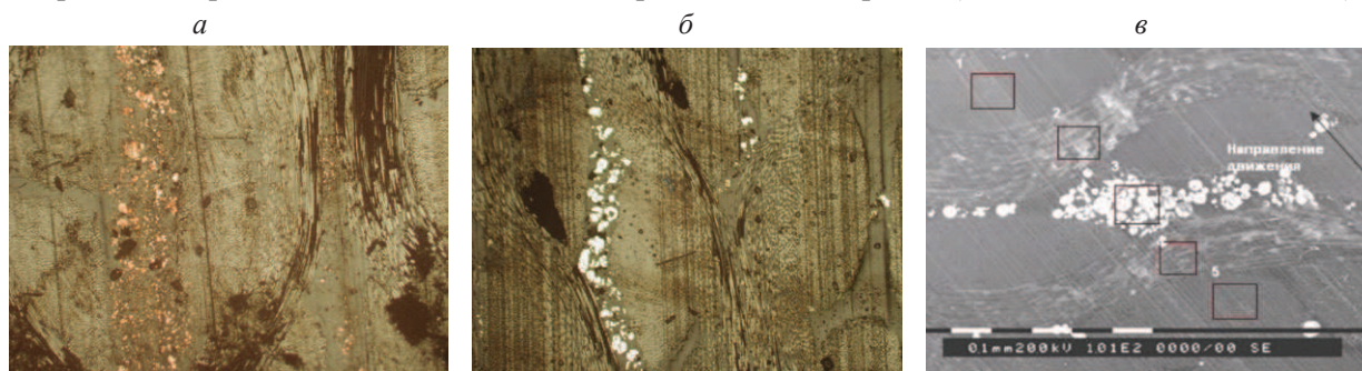
Рис. 3. Микрофотографии поверхностей трения модифицированных углепластиков ФУТ: а — нанопорошками Cu; б — Ni; в — баббитом Б83 [3]
