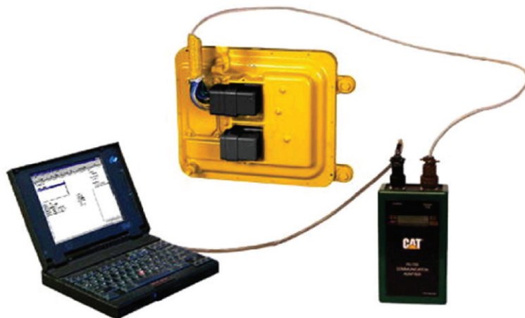
Рис. 1. Общий вид диагностического оборудования CAT ET
