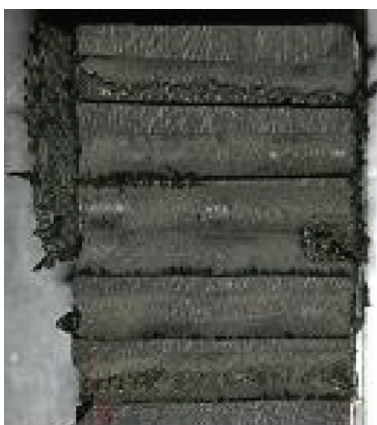
Рис. 1. Дефекты поверхности после механической обработки:
