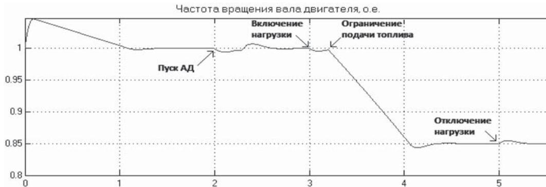
Рис. 2. Переходные процессы при изменении нагрузки ДГА
