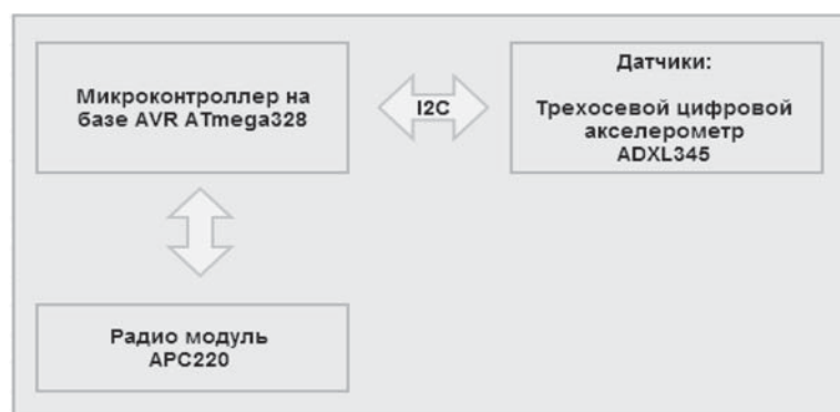
Рис. 1. Структура измерительного блока
