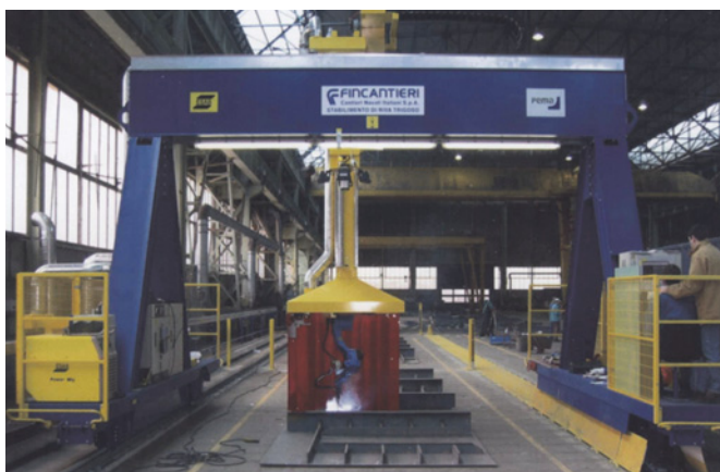
Рис. 1. Использование роботов для изготовления корпусных металлоконструкций:
