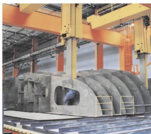
Рис. 1. Использование роботов для изготовления корпусных металлоконструкций:
