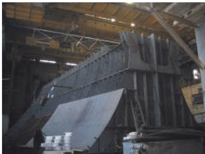
Рис. 5. Сборка корпусной конструкции на каркасе
