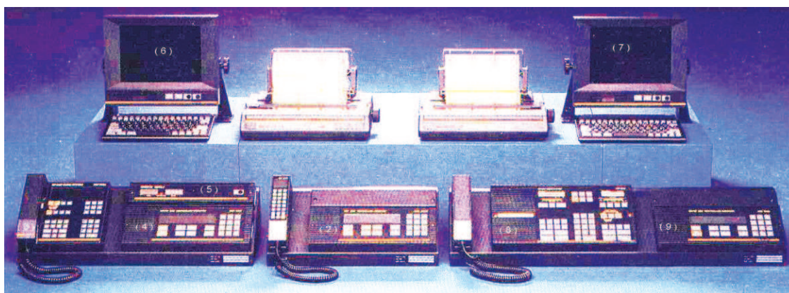
Рис. 4. Внешний вид системы связного мостика (SKANTI)
