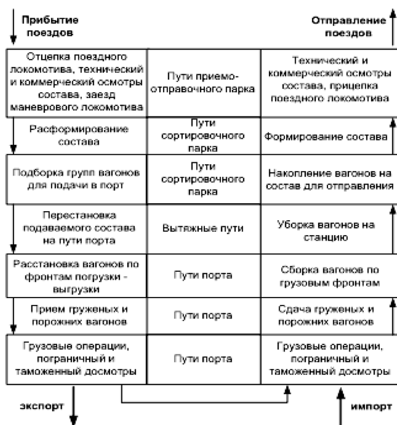
Рис. 1. Технологическая схема обработки экспортного и импортного вагонопотоков
