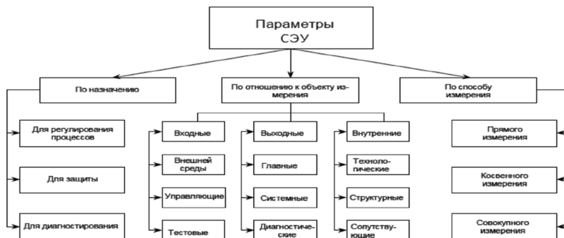
Рис. 1. Классификация параметров СЭУ
