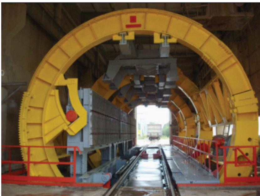
Рис. 1. Вагоноопрокидыватель роторный стационарный четырехопорный
