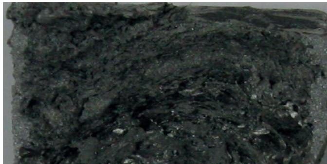
Рис. 6. Пластинчатая структура в центре твэл при интенсивном охлаждении поверхности
