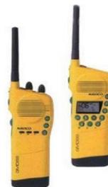
Рис. 5. Радиооборудование спасательных средств
