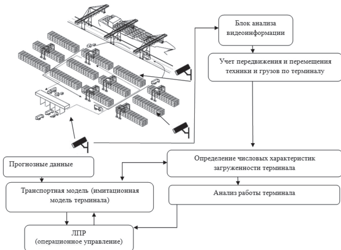
Рис. 4. Принципиальная схема использования транспортной модели на основе анализа видеоинформации с использованием имитационной модели контейнерного терминала
