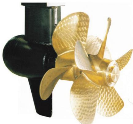
Рис. 9. Винторулевые колонки фирмы «Aquamaster» с винтами противоположного вращения
