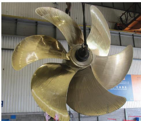
Рис. 1. Винт фиксированного шага фирмы «Wärtsilä»
