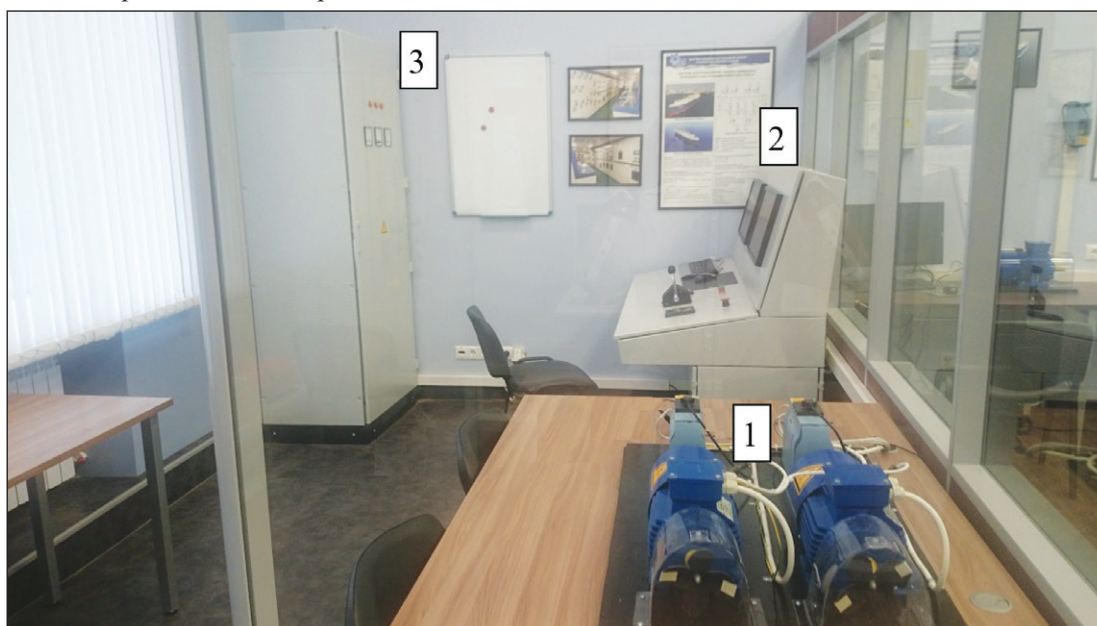
Рис. 6. Фотография тренажерного комплекса ЕЭЭС с гребной электроустановкой: 1 — физическая модель двухвальной ГЭУ; 2 — пульт управления; 3 — ГРЩ
