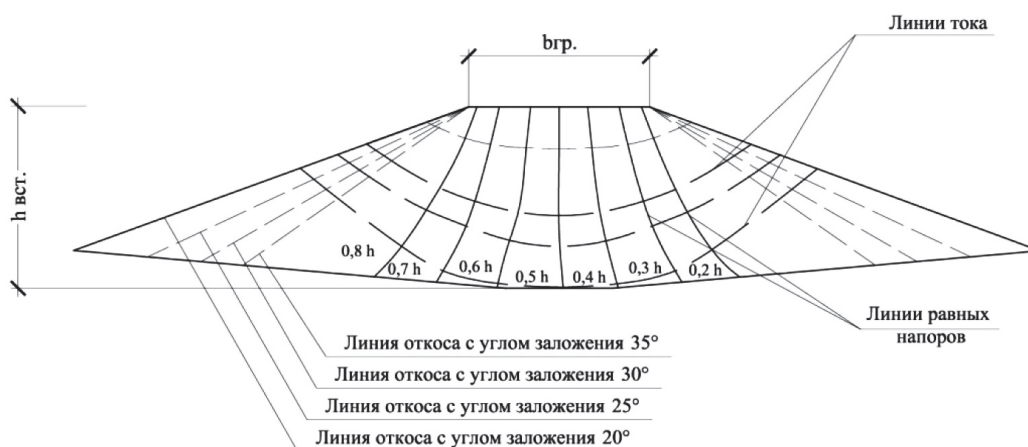
Рис. 9. Расчётная схема размыва грунтовой вставки в трубчатом водосбросе
