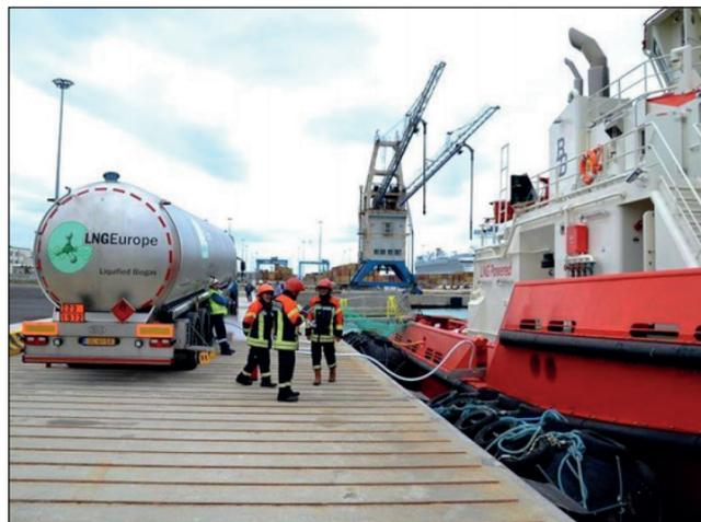
Рис. 2. Бункеровка судна с использованием автоцистерн
