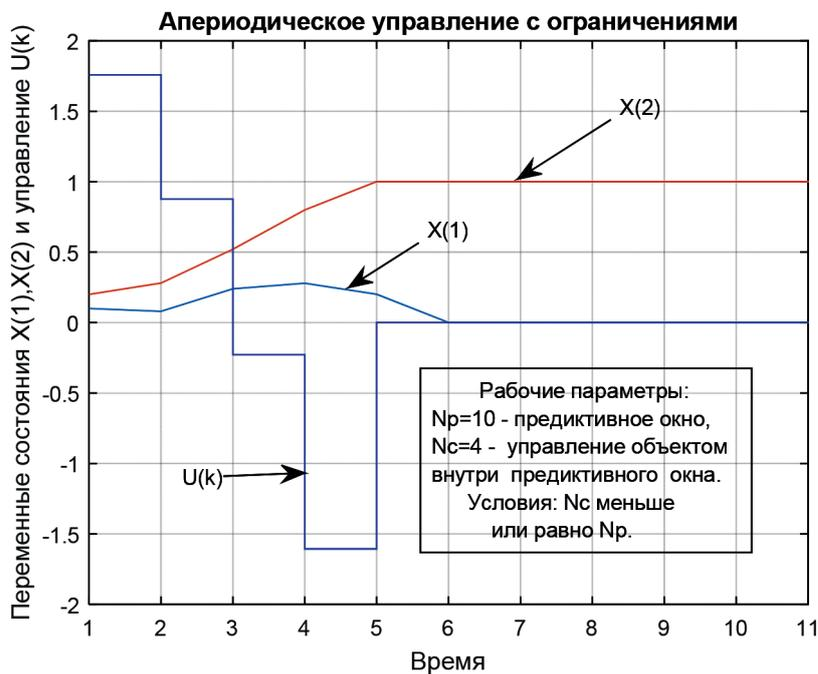
Рис. 2. Управление объектом при  $N_p = 10$  и  $N_c = 4$
