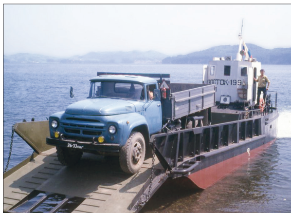
Рис. 2. Съезд бортового автомобиля с аппарельной баржи «Восток»
