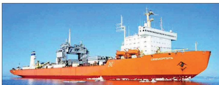
Рис. 12. Ледокольно-транспортное судно (лихтеровоз-контейнеровоз) с атомной силовой установкой «Севморпуть»
