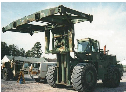
Рис. 8. Контейнерные автопогрузчики для пересеченной местности (Rough Terrain Container Handler, RTCH) армии США
