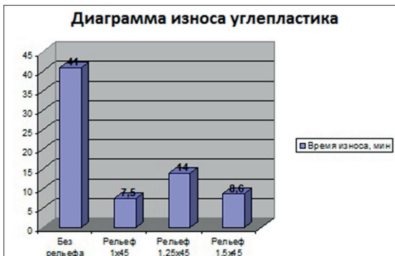
Рис. 6. Диаграмма, характеризующая износ углепластика в зависимости от характера нанесенного регулярного микрорельефа
