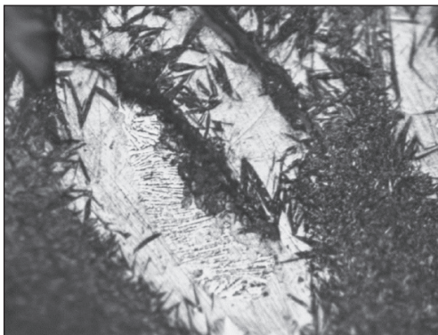
Рис. 9. Микроструктура вокруг включений графита в ЗТВ, \times 1000
