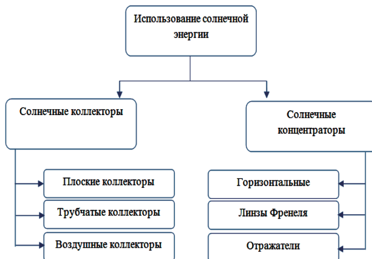
Рис. 1. Классификация методов преобразования солнечной энергии в тепловую энергию
