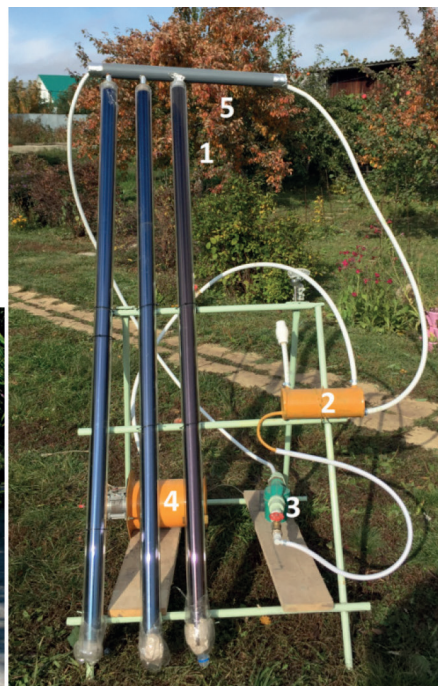
Рис. 3. Солнечный концентратор в форме тарелки (линзы Френеля) — а; экспериментальный стенд выработки электрической энергии за счет использования солнечной энергии — б;
