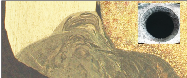
Рис. 10. Внешний вид и микрошлиф сварного соединения трубки круглого сечения с трубной доской
