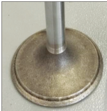
Рис. 19. Вид наплавленной поверхности клапана
