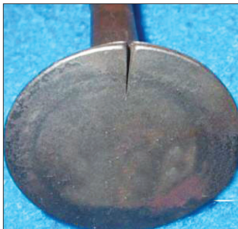
Рис. 14. Поврежденная поверхность клапана
