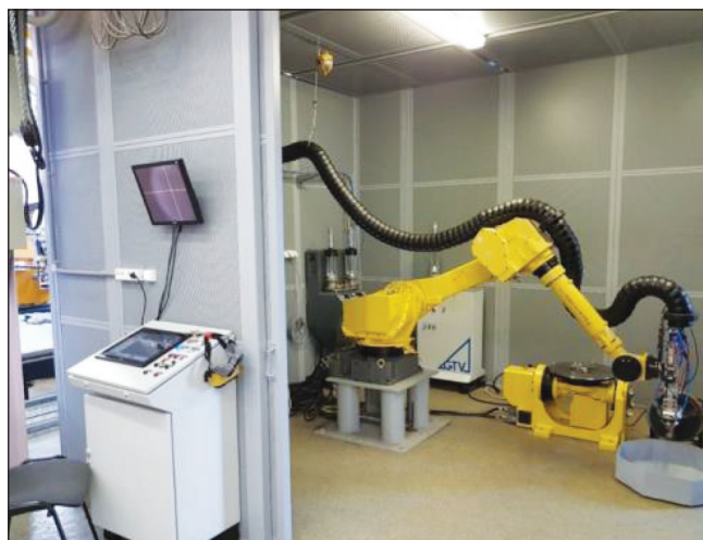
Рис. 13. Роботизированный комплекс лазерной порошковой наплавки
