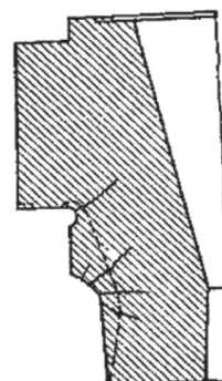
Рис. 3. Опорный бурт цилиндровой втулки двигателя типа ДКРН 74/160 [6]
