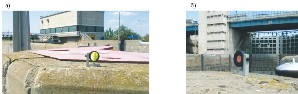
Рис. 5. Установка отражательных призм на секциях шлюзов:
