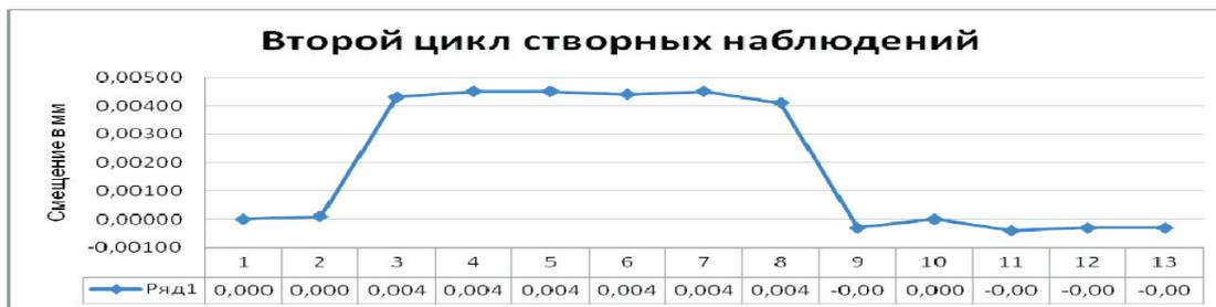
Рис. 13. Линейные измерения в створе восьмой секции шлюза № 30:
