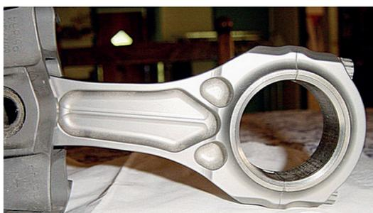
Рис. 1. Общий вид шатуна:
