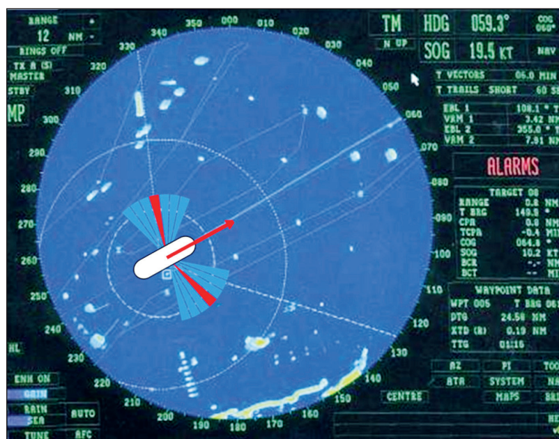
Рис. 6. Решение задачи изменения курса с использованием круговой диаграммы резонансных зон по килевой качке судна при помощи кальки с круговой диаграммой, наложенной на экран РЛС
