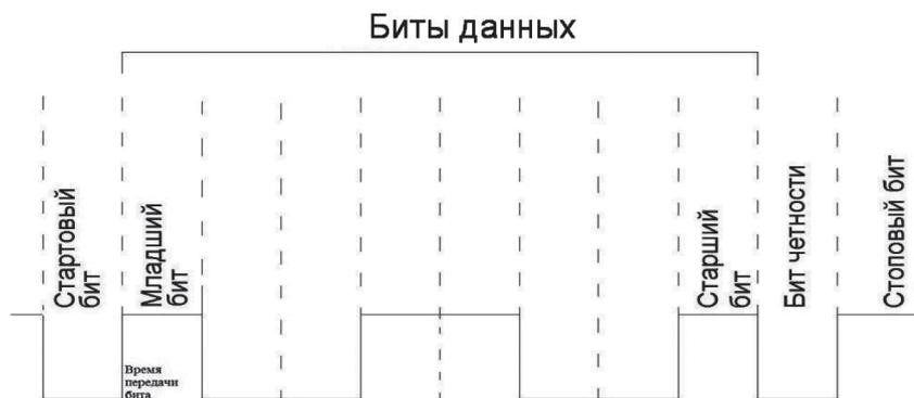
Рис. 4. Схема последовательности передачи данных
