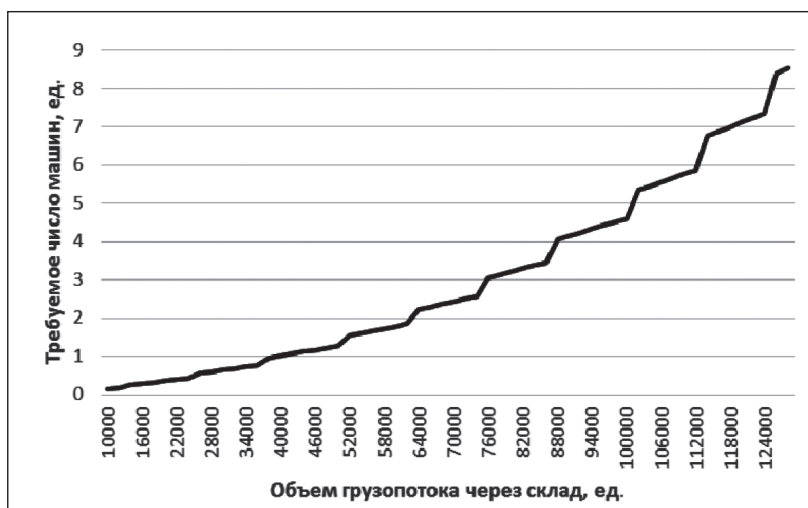
Рис. 7. Требуемое число складских машин как функция грузопотока
