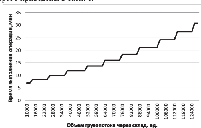
Рис. 4. Изменение длительности складской операции при росте грузопотока через склад
