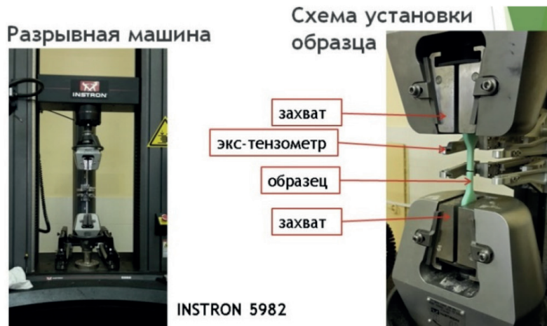
Рис. 5. Схема испытаний образцов на разрывной машине INSTRON 5982
