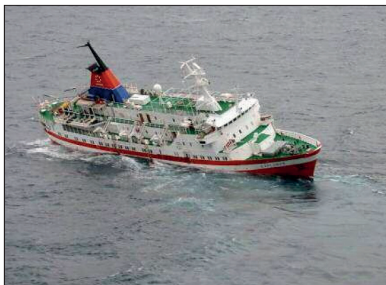
Рис. 5. Накренивание лайнера «Эксплорер» в результате поступления воды через пробоину
