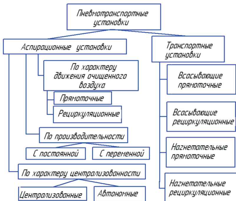
Рис. 2. Классификационная схема аспирационных и пылетранспортных установок, применяемых в системах вентиляции при механической обработке композиционных материалов
