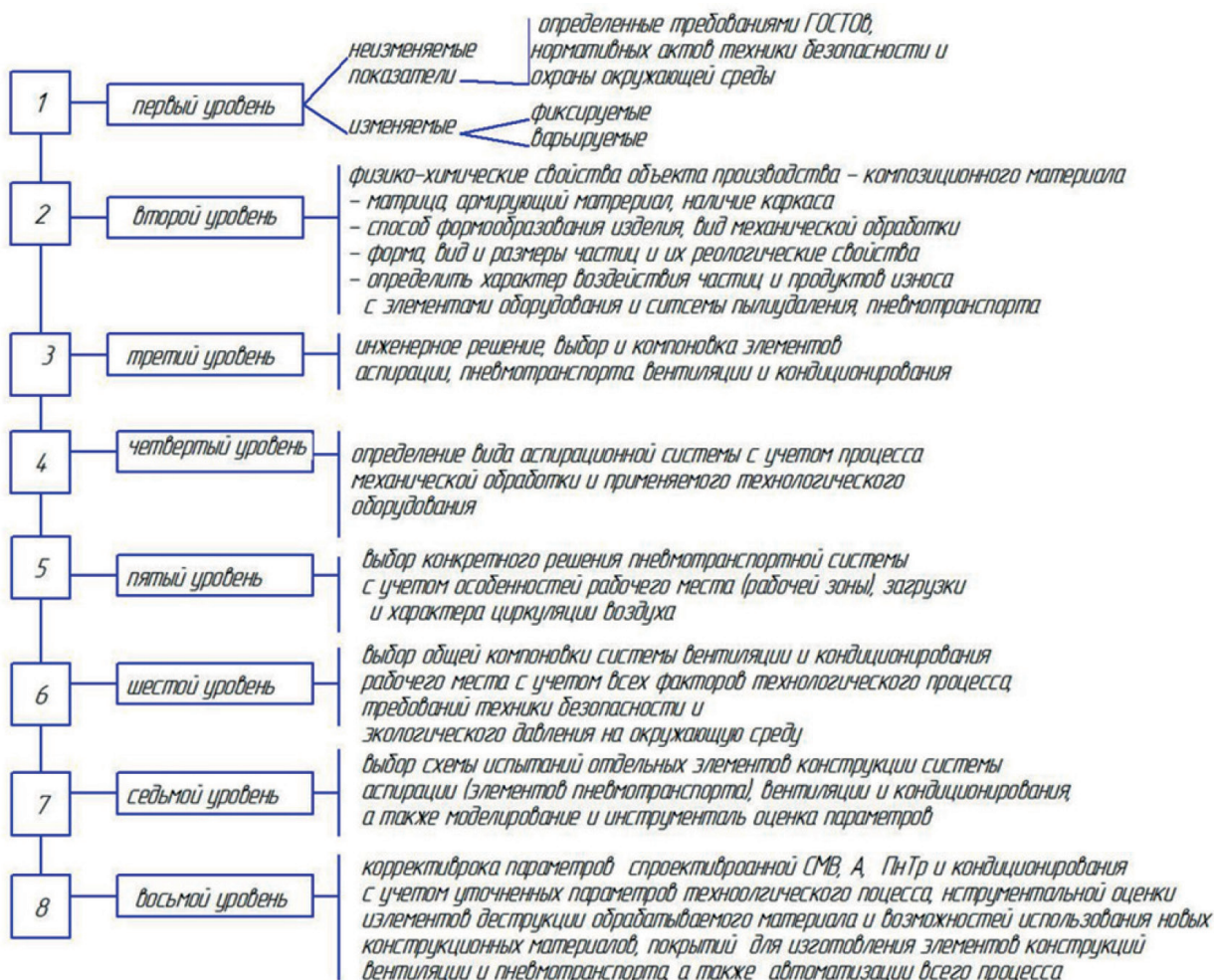
Рис. 1. Многоуровневая схема, иллюстрирующая алгоритм комплексный подход при выборе параметров системы вентиляции, аспирации, кондиционирования
