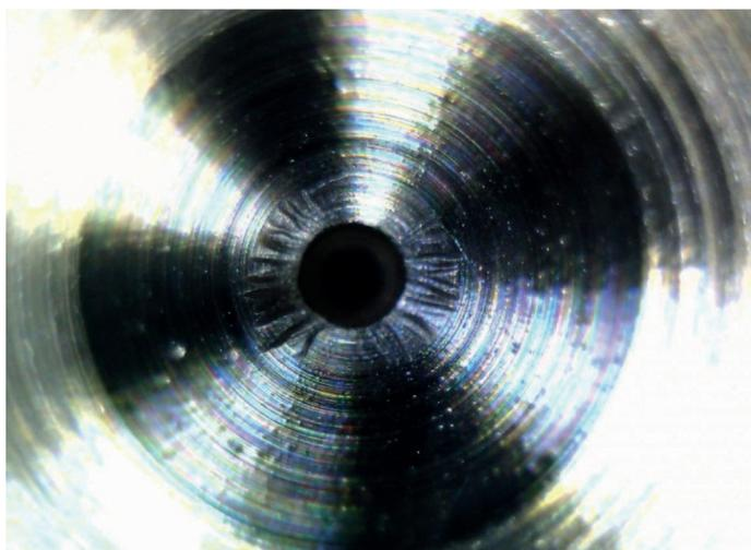
Рис. 5. Характерный вид износа седла клапана форсунки (микросъемка)
