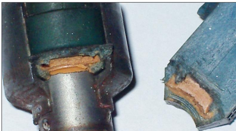
Рис. 6. Разрушение разъема под действием высокотемпературных агрессивных сред
