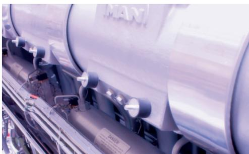
Рис. 14. Система *Common Rail* на двигателе MAN V32/44CR
