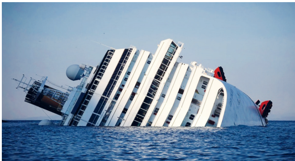
Рис. 4. К определению предельного угла крена, при котором возможен безопасный спуск шлюпок с поднятого (возвышенного) над водой борта
