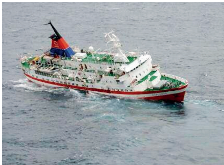
Рис. 7. Маневрирование лайнера «Эксплорер» путем выполнения зигзагов по принципу «Курс в сторону крена (пробоины)»
