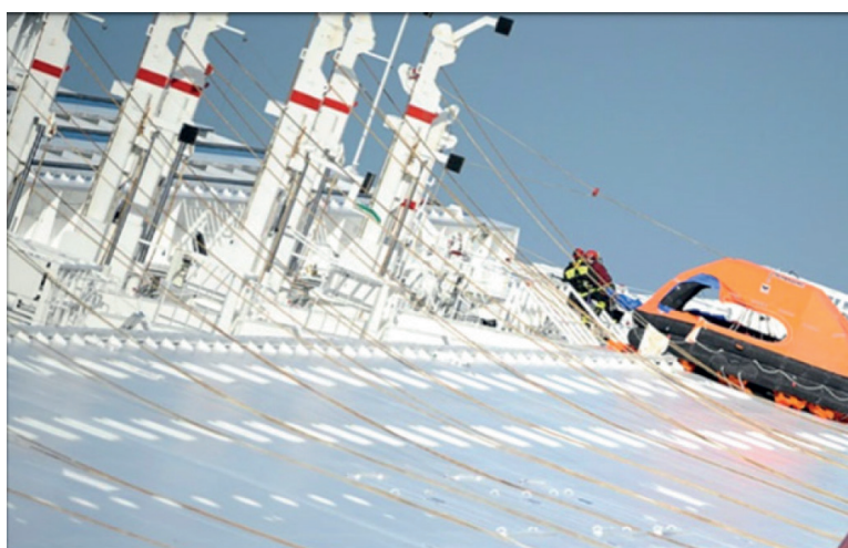
Рис. 10. Заранее вываленные за борт спасательные шлюпки на лайнере «Costa Concordia»
