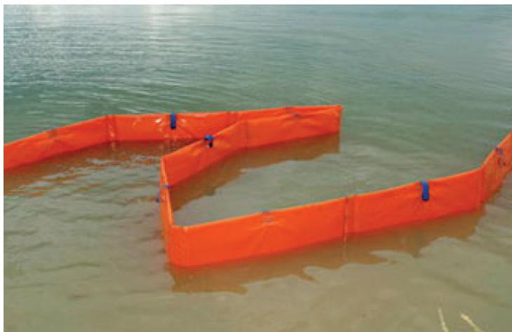
Рис. 3. Боновые ограждения постоянной плавучести
