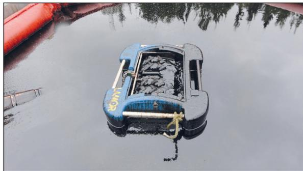
Рис. 6. Переносное нефтесборное устройство
