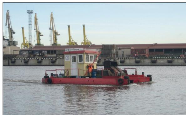
Рис. 7. Судно-нефтесборщик [<http://ff1.mosfont.ru/photo/01/10/46/110469.jpg>]
