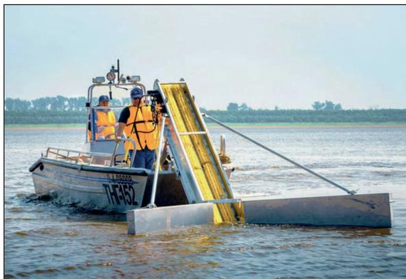
Рис. 8. Навесное нефтесборное устройство щеточного типа
