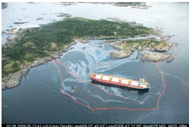
Рис. 1. Применение боновых ограждений при локализации аварийного разлива
