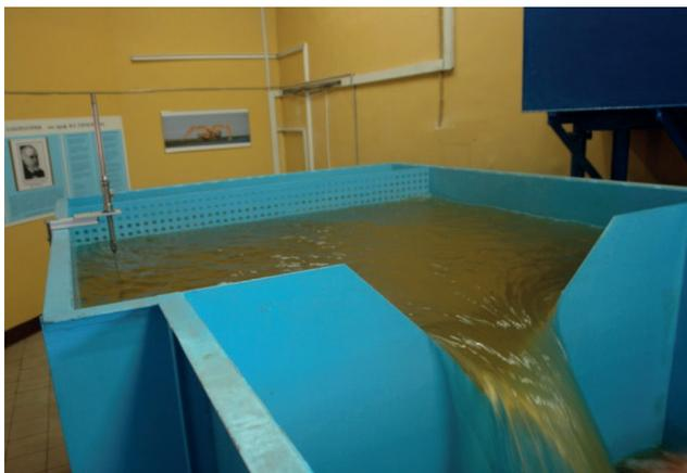
Рис. 8. Треугольный водослив в головной части лотка для определения расхода
