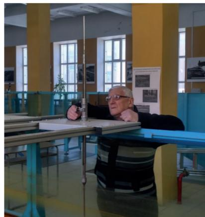
Рис. 9. Измерение отметок свободной поверхности шпигенмасштабом
