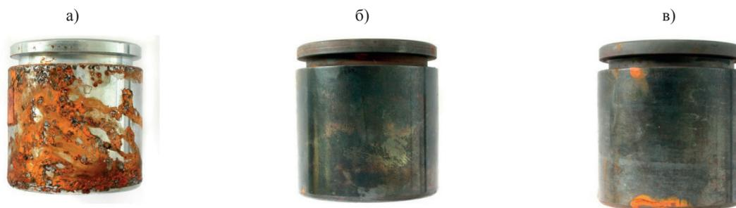
Рис. 2. Поверхность образцов после 48-часовых испытаний в камере соляного тумана с предшествующей обработкой:
