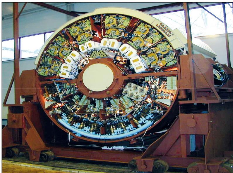
Рис. 2. ВДПМ мощностью 4 МВт со снятой крышкой на стенде «Новой Эры» — видны встроенные в корпус силовые полупроводниковые блоки
